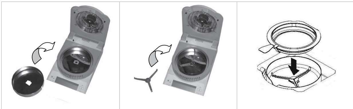
(1) Zugluftschutz installieren und positionieren
